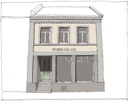
Ein Umbau der Ladenfassade mit sichtbaren Stützen und weniger Glasflächen. Das massive Obergeschoss steht auf einem sichtbar tragenden Erdgeschoss.
